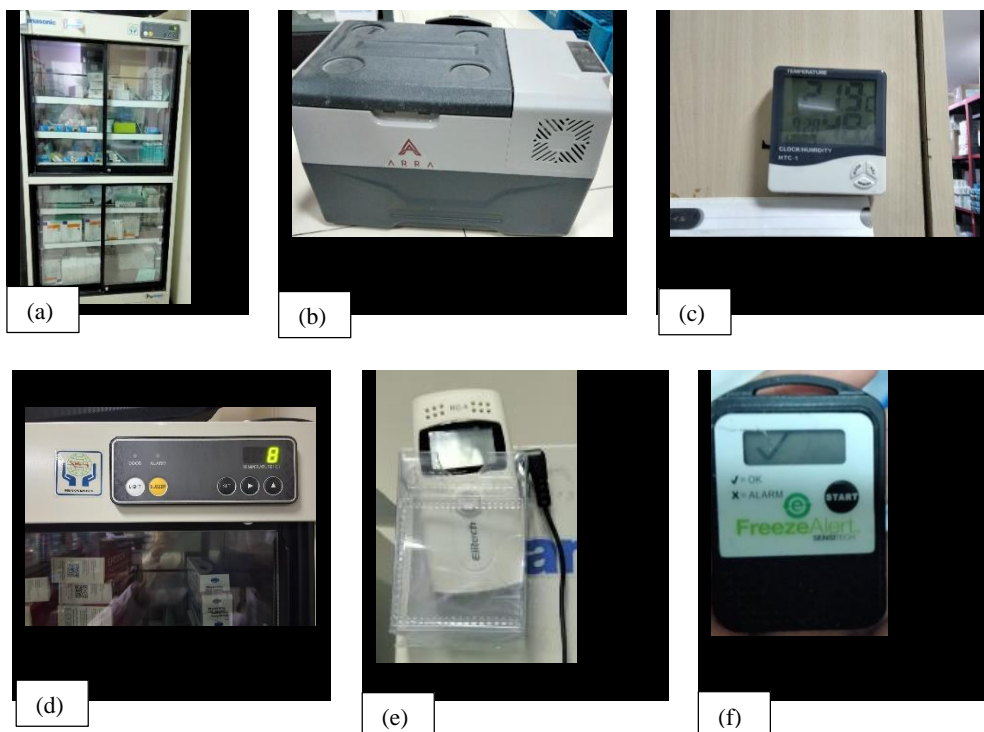
Gambar 1. Fasilitas Penyimpanan (a) Chiller / freezer atau lemari es, (b) Cold box , (c) Termometer ruangan, (d) Termometer freezer / lemari es, (e) Termometer data logger, (f) Alarm pencatatan suhu
