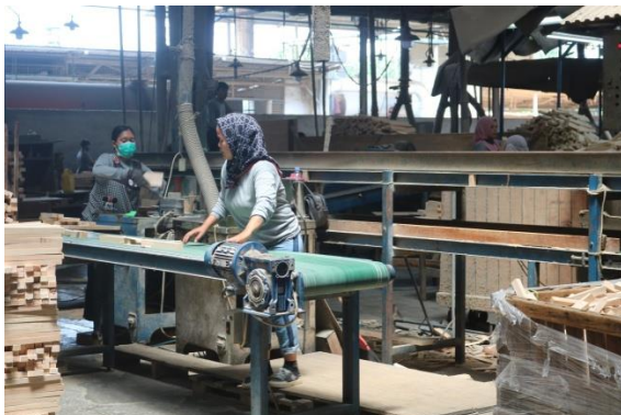
Gambar 5. Pekerja yang tidak menggunakan sarung tangan
