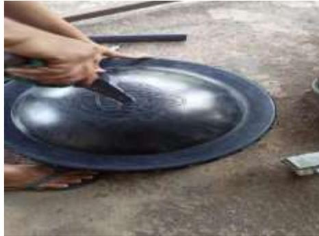
**Gambar 12 Pelubangan tutup digester**
