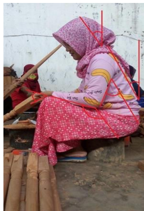
Gambar 3.1 Postur Tubuh Pekerja Pendempulan
