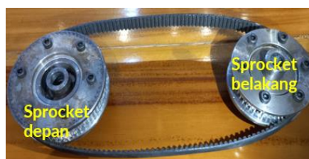
Gambar 2. Hasil pembuatan sistem pemindah daya synchronous belt
