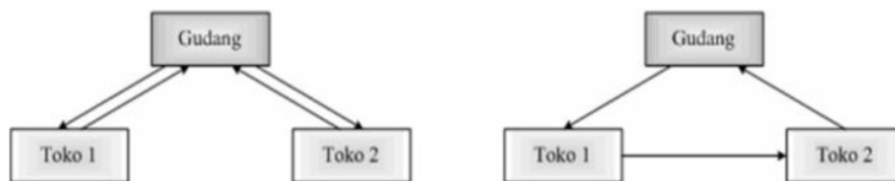
Gambar 2. Perbandingan Sistem Konvensional dengan Milk Run System
