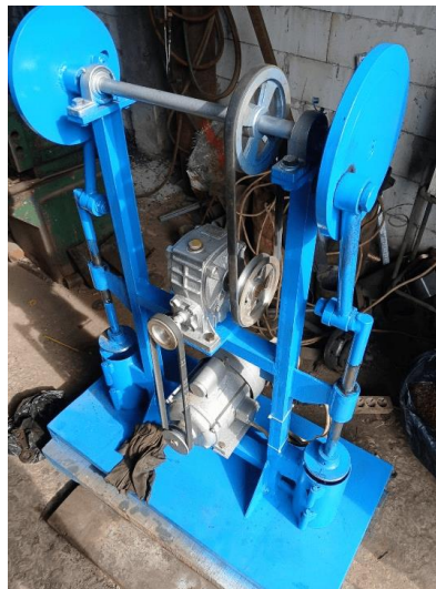
Gambar 3. Bentuk realisasi alat press baglog jamur tiram
