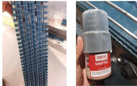
Gambar 4. 1 Pemasangan Modular Belt dan Catridge Automatic Lubricant
