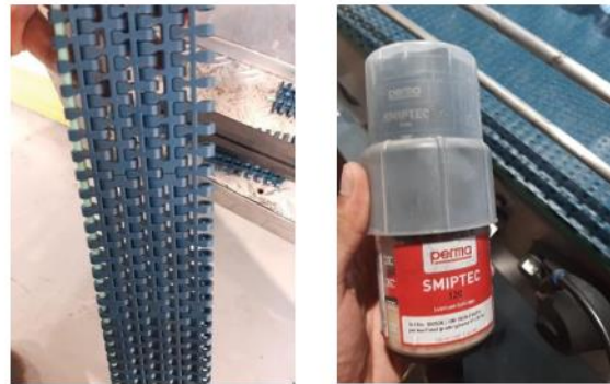
Gambar 4. 1 Pemasangan Modular Belt dan Catridge Automatic Lubricant
