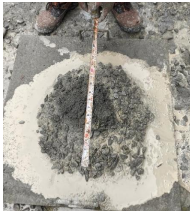
Gambar 4 Pengukuran panjang slump flow
