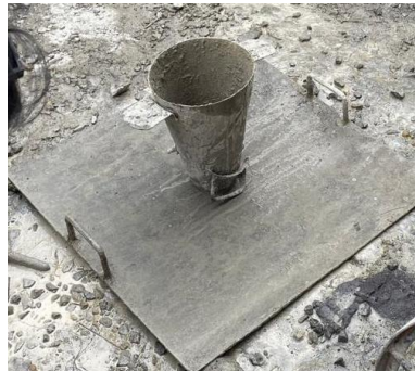
Gambar 1 Penempatan Slump Cone
