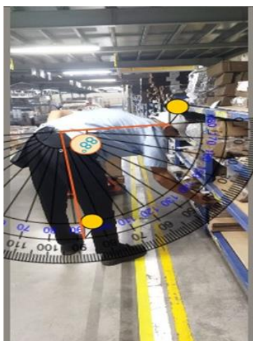
Gambar 9. pengukuran postur tubuh saat handling menggunakan busur derajat
