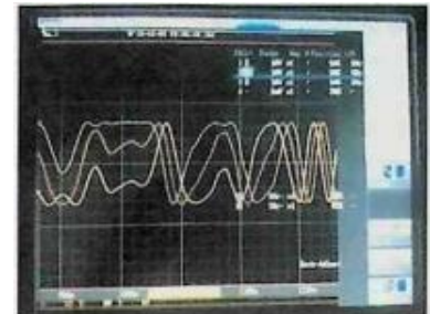
Gambar 3 Hasil pengukuran gelombang tegangan pada servo menggunakan Memori Hicorder
