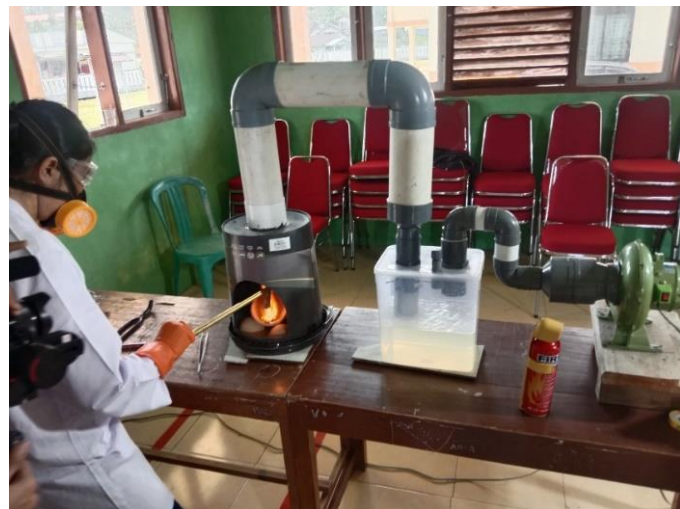
Figure 3 Alat Pelindung Diri dan Sistem Insentifator yang diaplikasikan di Koperasi Tombang Tujuh Loge
