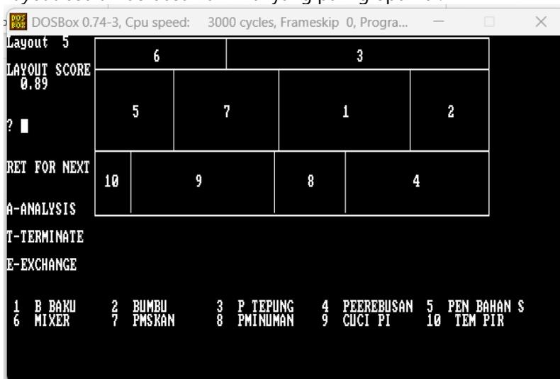
Gambar 8 *Layout* usulan 3 terpilih algoritma BLOCPLAN
