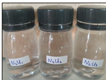
Gambar III Sampel larutan kitosan udang dengan NaCl 20.000 ppm
