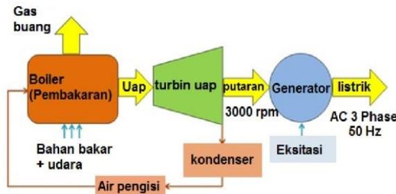
**Gambar 2. Prinsip kerja Pembangkit Listrik Tenaga Uap (PLTU)**
