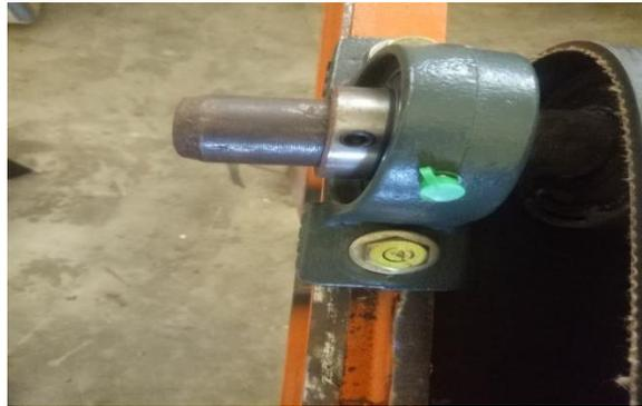
**Gambar** Rangka dudukan *bearing* dan setelan *roller*
