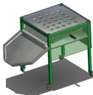
Gambar 2. Rancangan Alat Penghitung Pentol.
