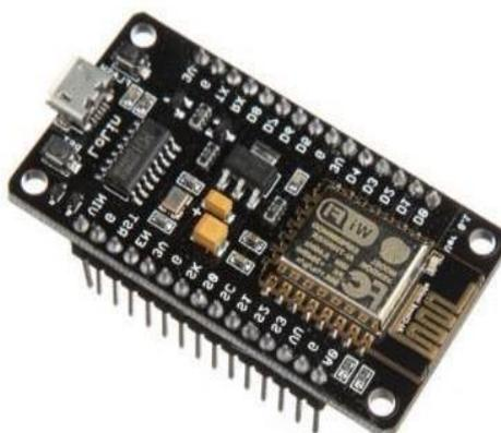
**Gambar 5. Mikrokontroler ESP8266**
