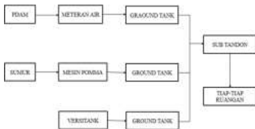
Gambar 18 Utilitas Air Bersih
