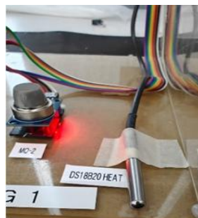
Gambar IV.4 Rancangan sensor DS18B20 Kode Program IV.3 Konfigurasi sensor suhu DS18B20
