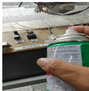
Gambar IV.3 Pengujian Sensor MQ-2
