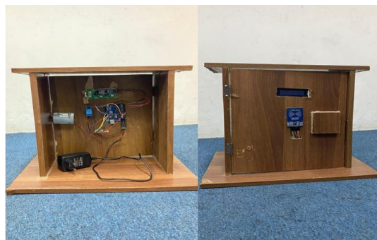
Gambar 2. Sistem pengamanan pintu berbasis RFID RC522
