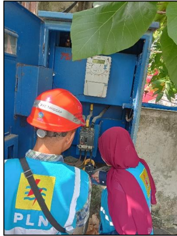
Gambar 2. Dokumentasi kegiatan mahasiswa magang saat melakukan pengukuran arus listrik menggunakan clamp meter bersama teknisi PLN.
