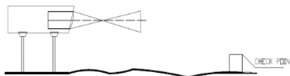
Gambar 10. Elevasi check point dan PAPI yang berbeda
