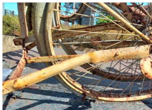
Gambar 4. Karat pada permukaan logam patung infinity (Sumber: Dokumentasi Tambak Sihno Purwanto)
