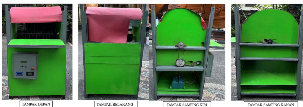
Gambar 2. Hasil Realisasi Mesin Perontok Padi (tampak depan dan belakang). Hasil Realisasi Mesin Perontok Padi (tampak kiri dan kanan)
