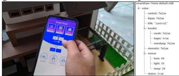
Gambar 10 Pengujian Mode Manual Jemuran Keluar
