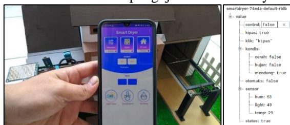
Gambar 8 Pengujian Sensor DHT11
