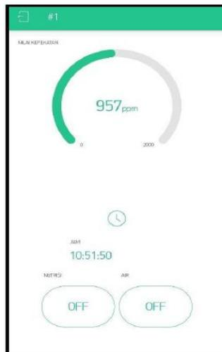
**Gambar 5 Tampilan Antarmuka Program Pengontrolan Nilai Kepekatan Nutrisi Tanaman Tomat dari Jarak Jauh**
