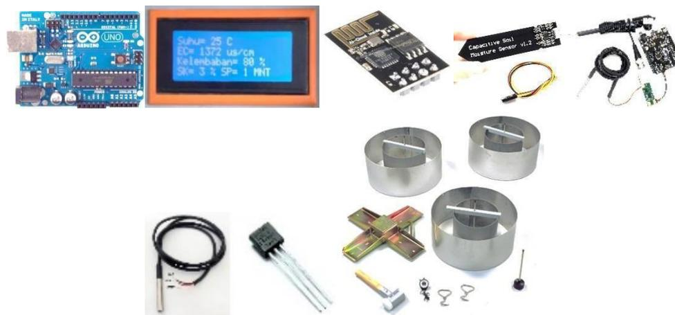
Gambar 1 : Double Ring Infiltrometer & Sensors
