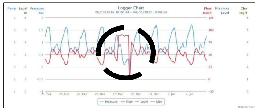
Gambar 9. Anomali Data yang Terlihat pada SCADA
