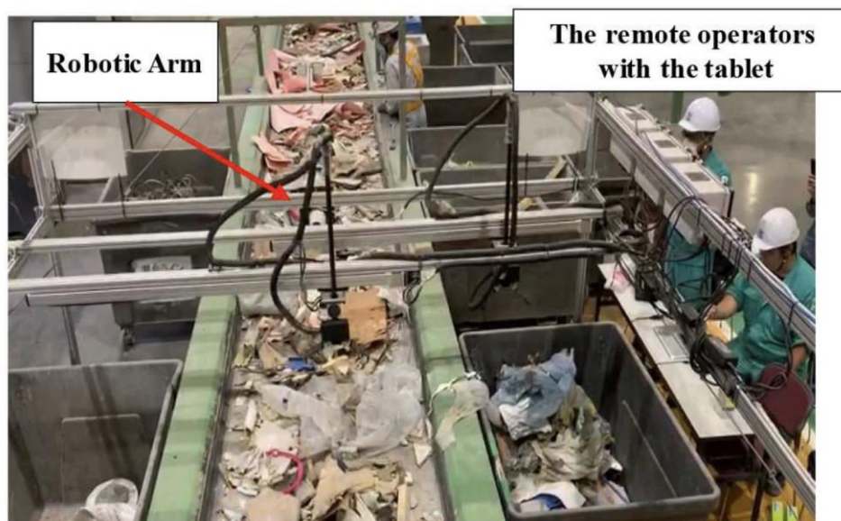
Gambar 1. Lengan Robotik dalam Fasilitas Pemilahan Sampah Jepang (Onoda, 2020)
