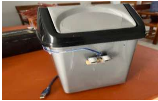
Gambar 1a. Tempat Sampah Pintar dengan menggunakan sensor gerak
