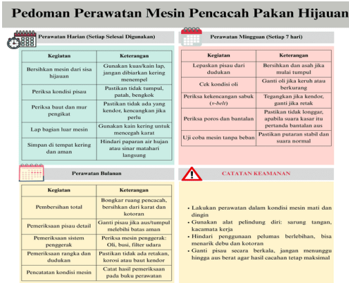
Gambar 7. Diagram SOP perawatan mesin pencacah pakan hijauan
