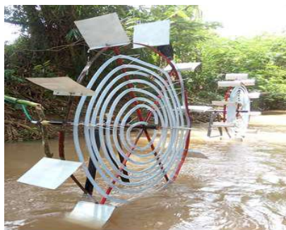
Gambar 5. Pengaplikasian Pompa Spiral Sebagai Irigasi Persawahan Di Lembang Randanan (Lokasi 2)
