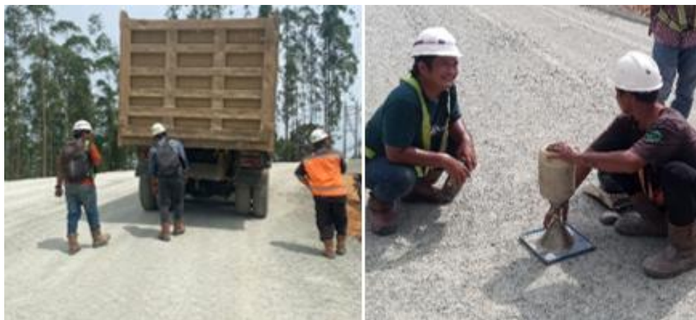
Gambar 2. Pengujian Sand Cone LPA dan Profoling.
