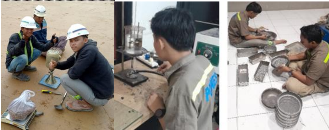
Gambar 1. (a) Pengujian Sand Cone Tanah Dasar; (b) Pengujian Material
