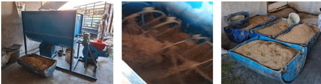
Gambar.2 Proses pengadukan bahan pakan dengan menggunakan mesin pencampur (horizontal mixer)
