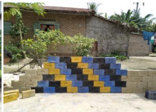
Gambar 4. Hasil Batu bata warna anti jamur setelah pembakaran dan dijemur
