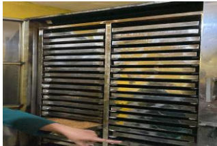
Gambar 3. Mesin Pengering Kapasitas 500 kg
