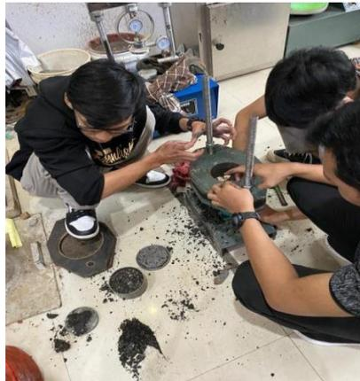
Gambar 3. Proses Pembuatan Sampel Aspal Beton Dengan Campuran Limbah Botol Plastik (PET)
