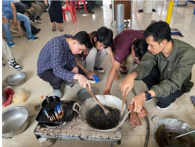
Gambar 2. Proses Pembuatan Aspal Beton dengan Campuran Limbah Botol Plastik (PET)
