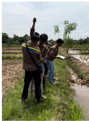
Gambar 6. Pelaksanaan Uji DCP titik 3 di lokasi Jalan Usaha Tani, Desa Manunggal Jaya, Kab. Kutai Kertanegara, Kalimantan Timur
