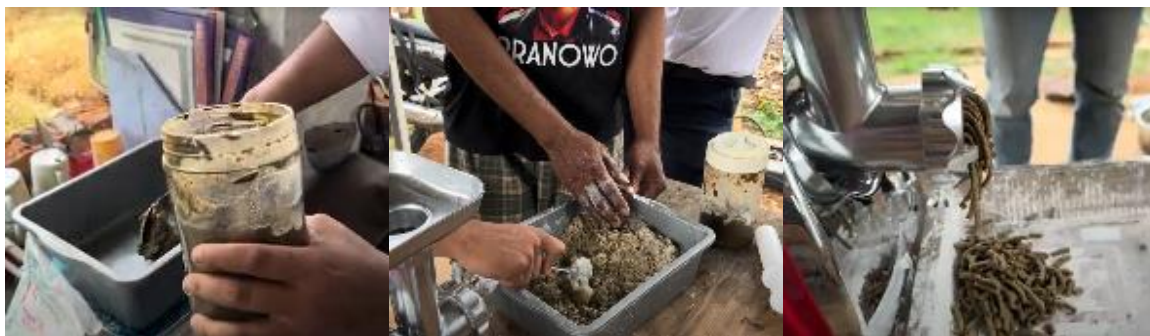
Gambar 5. Pembuatan Pelet Maggot
