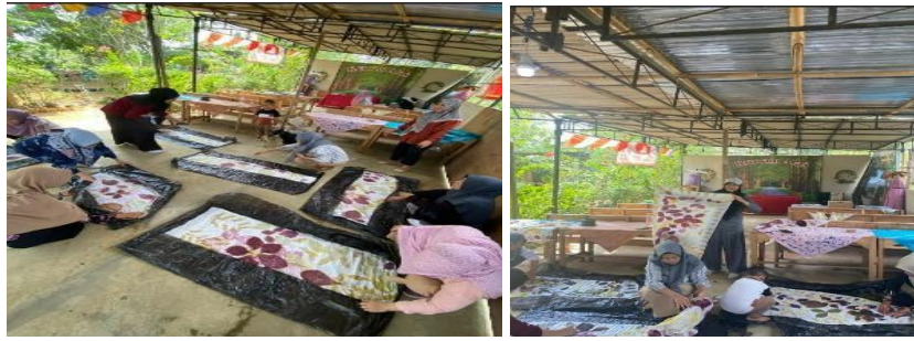
Gambar 1. Proses pembuatan dan Pembukaan kain ecoprint setelah di kukus kurang lebih 2 jam
