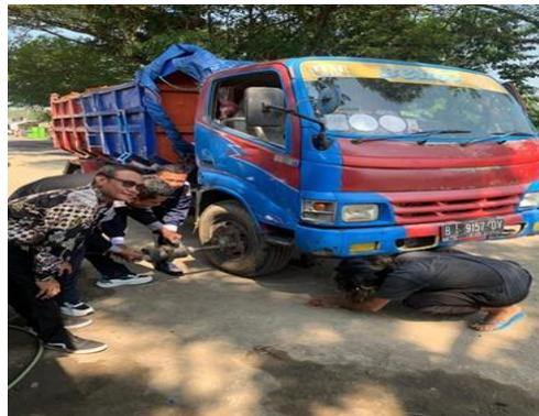
Gambar 2 Proses pelepasan ban dengan air impact wrench
