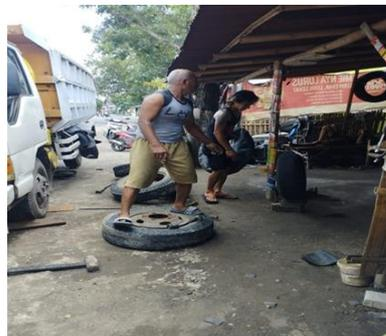
Gambar 3 Proses pelepasan ban dari pelek
