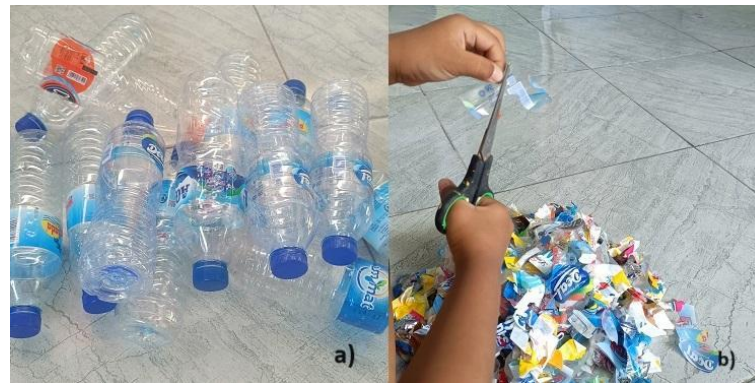
Gambar 2. a) sampah botol plastik bekas sebagai wadah ecobrick, b) pencacahan lembaran sampah plastik sebagai isian ecobrick
