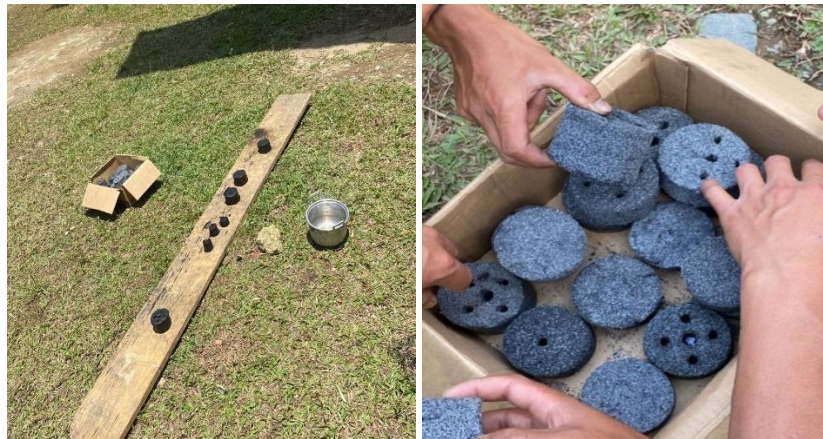
Gambar 5 Proses Pengeringan Briket Sekam Padi dan Briket Sekam Padi Yang telah dikeringkan
