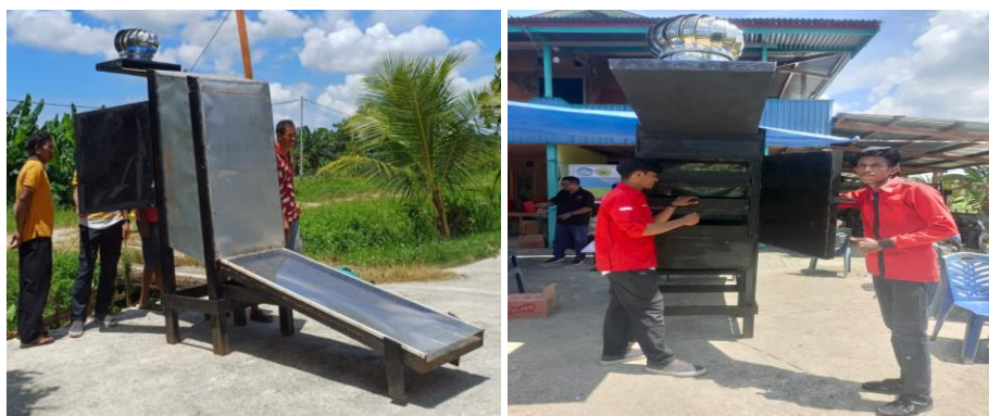
Gambar 1. Solar dryer tipe rak bertingkat dengan kolektor sekunder dan turbin ventilator
