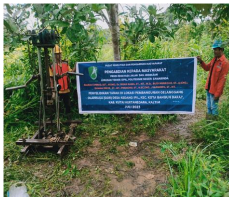
Gambar 2. Pelaksanaan Uji Sondir titik 1 di lokasi Pembangunan Gelanggang Olahraga Desa Kedang Ipil
