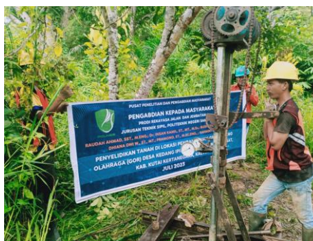
Gambar 3. Pelaksanaan Uji Sondir titik 2 di lokasi Pembangunan Gelanggang Olahraga Desa Kedang
