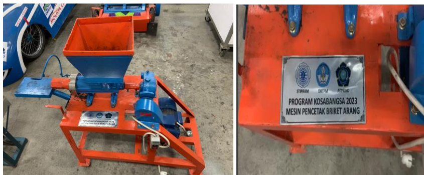
Gambar 3. Teknologi tepat guna alat pembuat briket arang Sumber: Dokumentasi Tim PKM 2023
