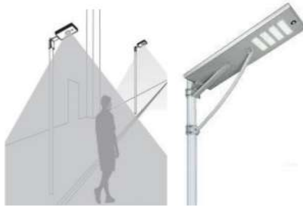
Gambar 3. Desain Perancangan PJU tenaga Surya
