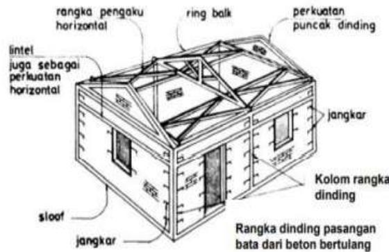
Gambar 2. Rangka Sederhana Konstruksi Rumah Tinggal
